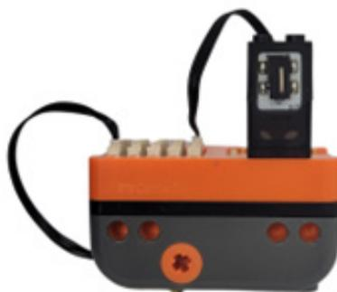
Montagem do LudoBot utilizando o sensor de toque
